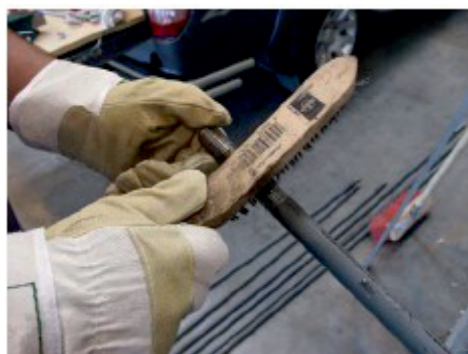
Závity očistěte drátěným kartáčem
