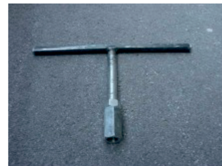
Vratidlo typu T k osazování tyčí dvojitého spínacího táhla
