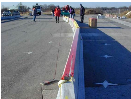
Uzavřená řada dílců po nárazové zkoušce TB 41 u systému DB 50S
