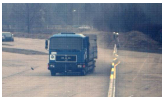
Zkouška TB 41 pro stupeň zádržnosti T3 (nákladní automobil 10 t, 70 km/hod., úhel 8°)
